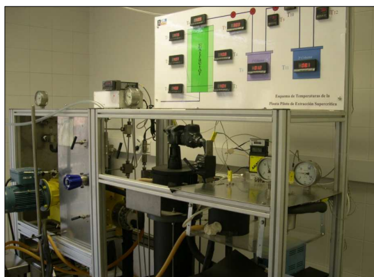
Figura 6. Planta de laboratorio de extracción con fluidos supercríticos
