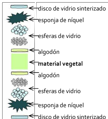
Figura 8. Disposición del material vegetal en el lecho de extracción
