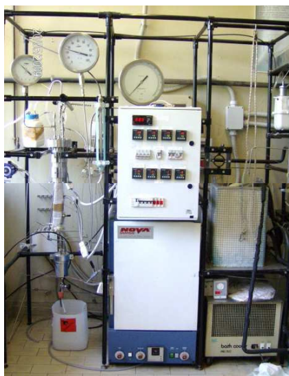
Figura 15. Planta de fraccionamiento supercrítico antidisolvente
