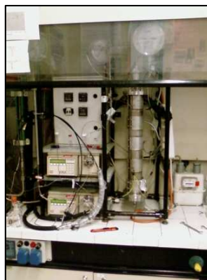
Figura 21. Planta de atomización mediante fluidos supercríticos (SAA).
